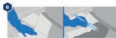
Réalisez un demi-rond avec TKROM ANTIGOTERAS ou TKROM CUBIERTAS et du sable de quartz de 0,4 mm (2:1 en volume).
