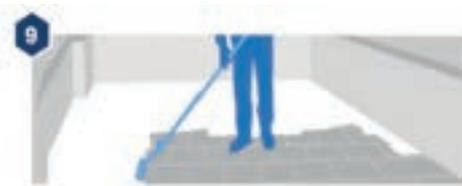
Appliquez une nouvelle couche de TKROM ANTIGOTERAS ou TKROM CUBIERTAS pour recouvrir parfaitement le treillis en fibre de verre.
