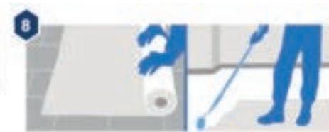
TKROM ANTIGOTERAS ou TKROM CUBIERTAS + treillis en fibre de verre pour terrasses 60gr/m<sup>2</sup>.
