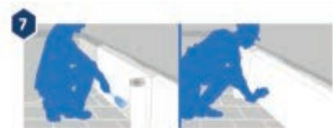
Reforço lateral do terraço com malha de fibra de vidro para terraços 60gr/m<sup>2</sup>.
