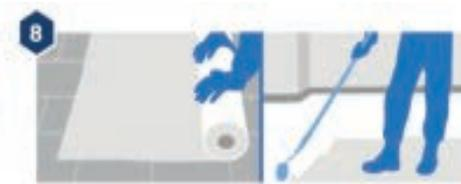
TKROM ANTIGOTERAS ou TKROM CUBIERTAS + rede de fibra de vidro para terraços 60gr/m<sup>2</sup>.
