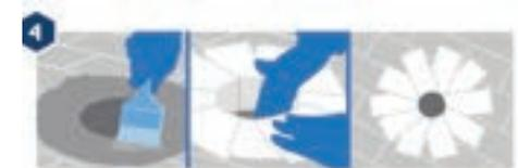
Reforço de drenos com malha de fibra de vidro para terraços 60gr/m<sup>2</sup>.
