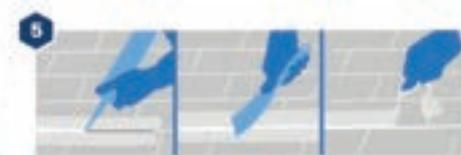
Repare as juntas com massa de enchimento de juntas com movimento e com o produto adequado.
